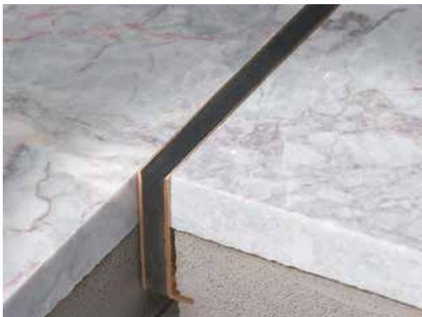
Joint de dilatation en métal avec insert polissable en EPDM, spécifique pour la pose de Palladiana, marbre et granit, qui doit être soumis par la suite à des traitements de finition: ponçage et polissage sur site. Il peut être installé lors de la pose du revêtement . Domaines d'application typiques: centres commerciaux, aires de récréation comme hôtels, centres sportifs et écoles.
